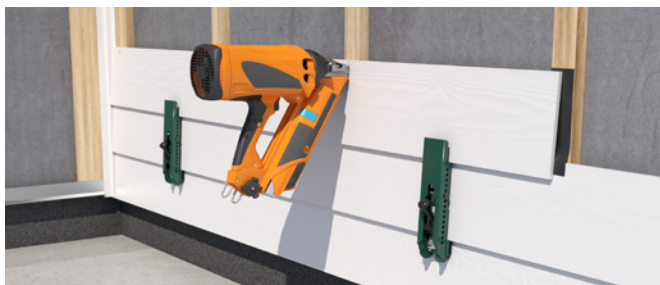
4. Befestigen durch Nageln oder Schrauben (ohne Vorbohren)
