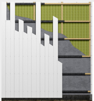
Anordnung der Boden-Deckel-Schalung.
