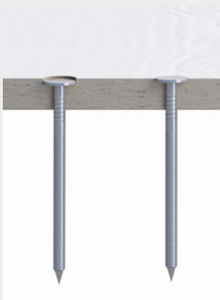
Befestigungsmittel bündig mit Oberfläche oder max. 1mm versenkt eintreiben.
